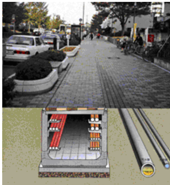
Strada infrastrutturata con cunicolo tecnologico
